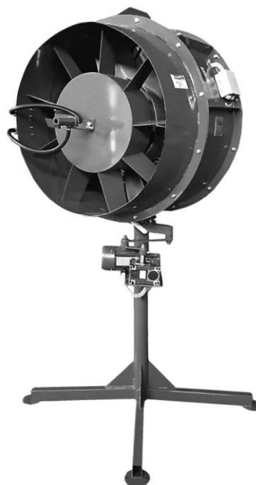
вода в количестве достаточном для увлажнения. Для исключения засорения форсунки необходимо предусматривать предварительную очистку подаваемой на аэратор воды. Сжатый воздух и вода подается в форсунку через гибкие шланги.
