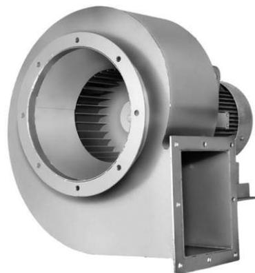
Улитка - изготавливается с углом разворота от  $0^{\circ}$  до  $270^{\circ}$  через  $15^{\circ}$ , при этом ребра улитки, мешающие при установке, подрезаются.
