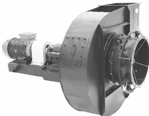
Улитка вентилятора изготавливается с углом разворота от 0° до 270° через 15°, при этом ребра улитки, мешающие при установке, подрезаются.
